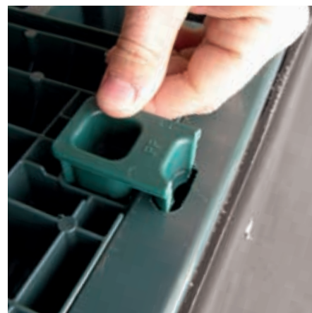
Sécurisation avec raccord de fixation
